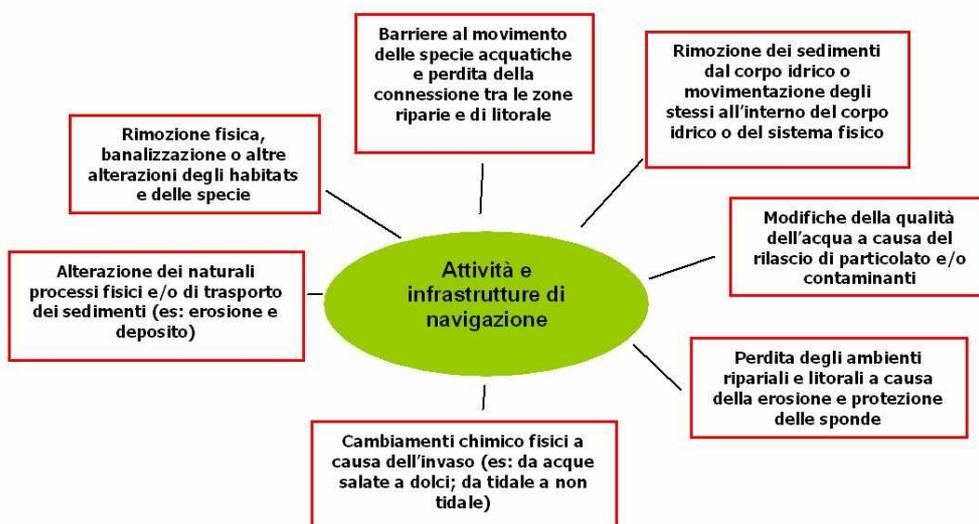
Figura 2 - Possibili alterazioni associate alla navigazione fluviale (da EU CIS 2006)
