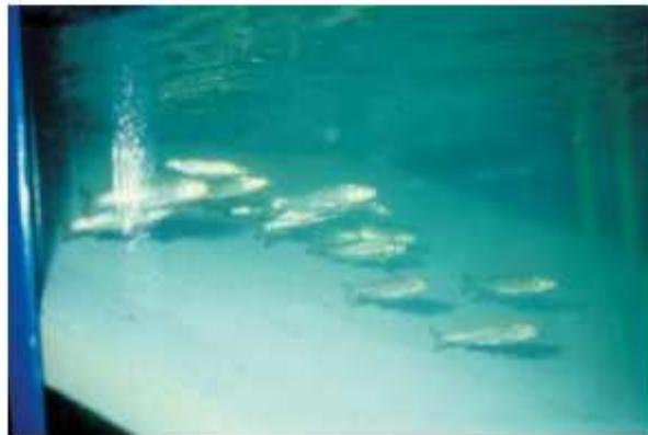
Figura 64. Test di laboratorio su salmoni; nuoto statico (=Vel corrente) a monte di un grigliato (da DWA, 2005)
