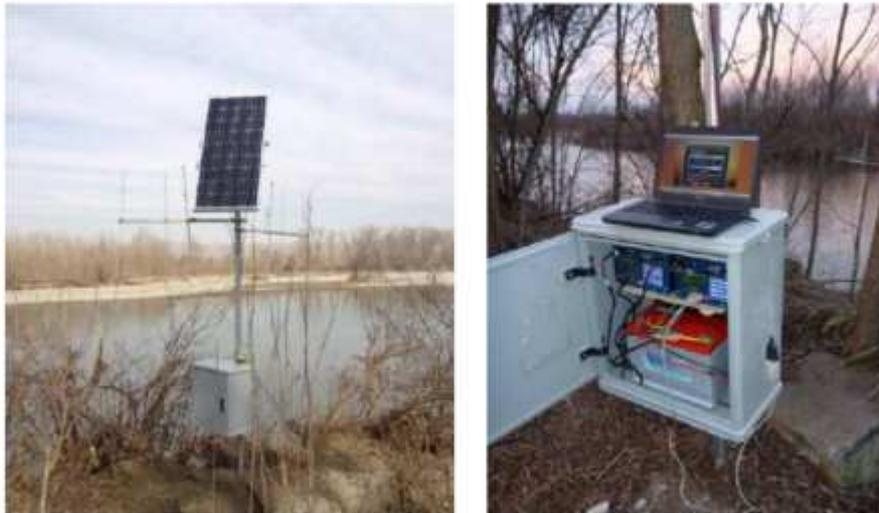
Figura 77. Stazioni di rilevamento automatico alimentate con pannelli fotovoltaici sui fiumi Po e Dora Baltea (foto Comoglio)
