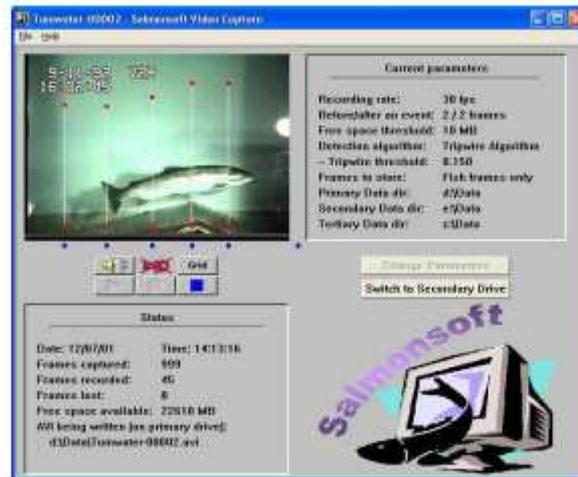
Figura 80. Schermata tipo di software commerciale per analisi delle immagini registrate nei passaggi (da Salmonsoft)
