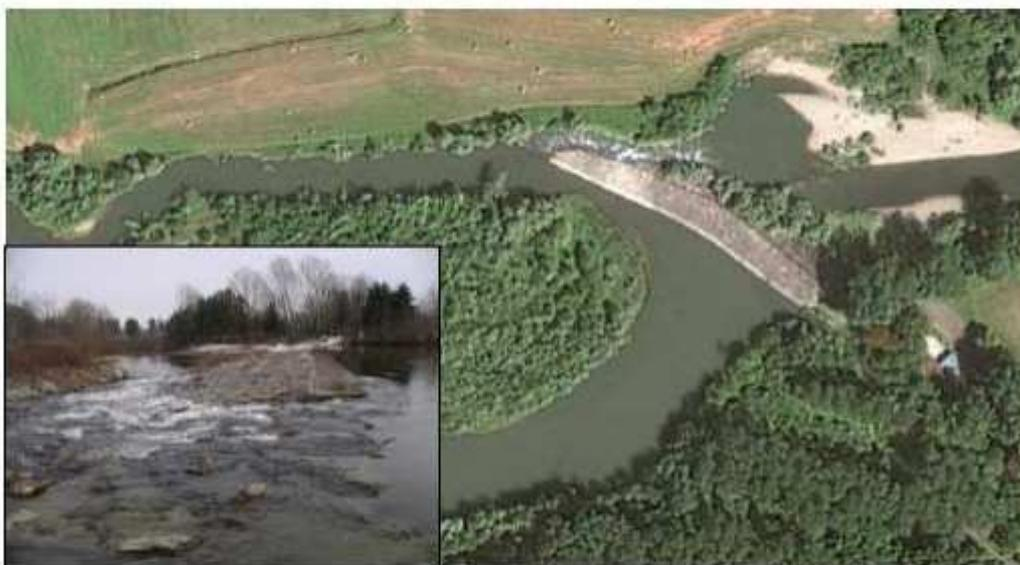
Figura 8. Esempio relativo al caso a): fish ramp in sponda sinistra sul torrente Chiusella, vista aerea e da monte su passaggio (da Google maps; foto Comoglio)
