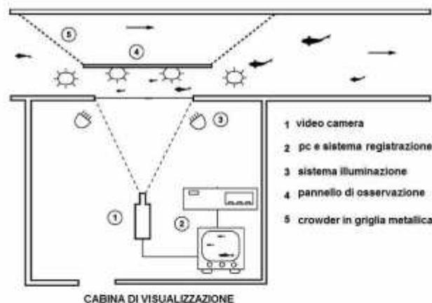
Figura 79. Schema tipo di cabina di visualizzazione attrezzata (da Larinier, 2002, modificato)
